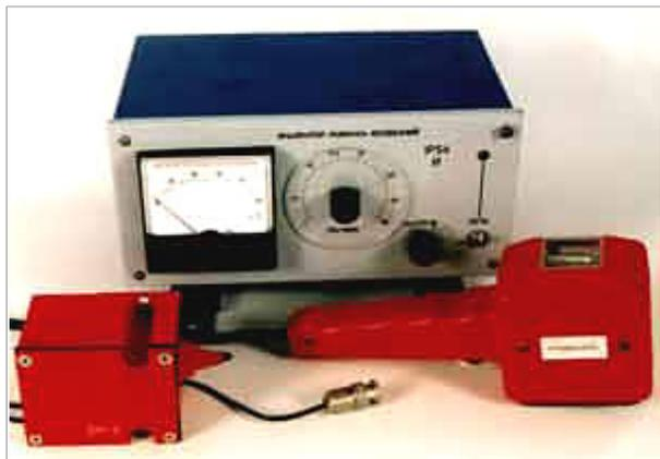
Индикатор электронный ВБВ-005 предназначен для индикации виброперемещения вращающихся деталей (роторов) при наличии у последних неуравновешенности масс.
