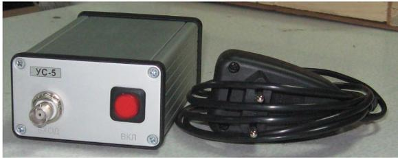
Устройство согласующее виброизмерительное УС-5 предназначено для согласования выходного сопротивления вибропреобразователя пьезоэлектрического с входным сопротивлением измерительных приборов (вольтметр, измерители нелинейных искажений, анализаторы спектра, осциллографы и т.д.). Устройство предназначено для работы в составе измерительных комплексов при калибровке, аттестации и эксплуатации калибровочных, поверочных и испытательных виброустановок.
