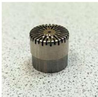
Предназначен для использования в шумоизмерительной аппаратуре в качестве измерительного преобразователя инфразвукового и звукового давления. Звуковые колебания мембраны преобразуются в переменное напряжение, пропорциональное воздействию на капсюль звуковому давлению.
