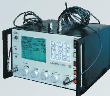
Аппаратура БАЗИС-001 предназначена для измерения параметров вибрации, задания и автоматического поддержания параметров вибрации, контроля спектра вибрации и определения резонансных частот в составе вибрационных электродинамических испытательных установок серии ВЭДС (серийно выпускающихся ПО «Виброприбор») и аналогичных им.
